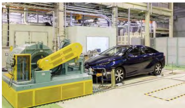
図13 シャシダイナモメータを用いた電動車両の性能評価例
