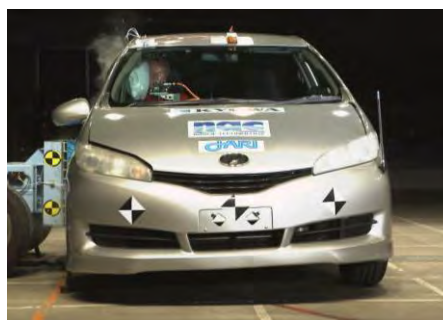
図30 走行台車による側面衝突試験
