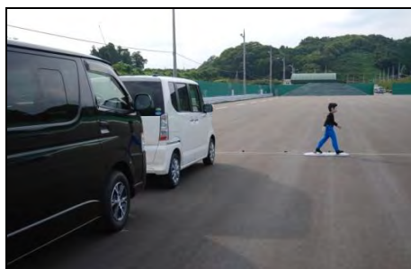
図31 AEBSの対歩行者評価試験 [遮蔽シナリオの一例]
