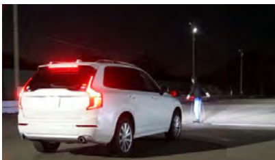
図28 AEBS試験用歩行者ターゲット(夜間試験の様子)
