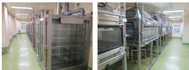
図3 自動車排出ガス吸入暴露装置 (左：大型チャンバ、右：中型チャンバ)
