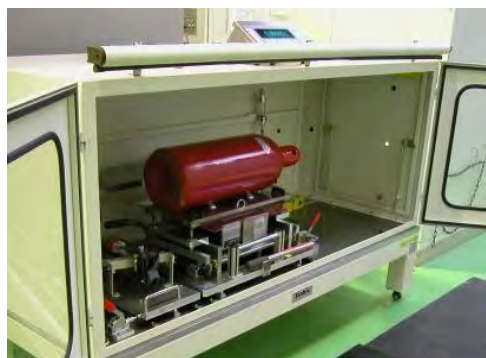
図14 質量法によるFCVの水素消費量計測例
