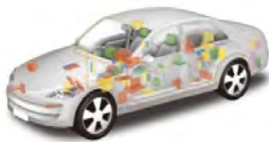
図 38 現在の車のE/Eシステム(車載ECU)搭載イメージ
