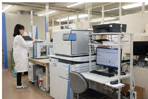
図10 排気中の微量有害成分測定
