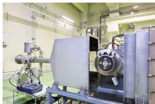
図11 エンジンダイナモメータを用いたブレーキ粉塵試験
