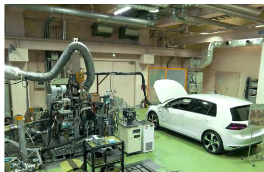
図12 エンジンダイナモメータを用いたベンチマーク試験
