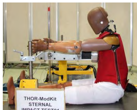
図22 人体忠実度の高い前面衝突用人体ダミーに対する衝撃試験
