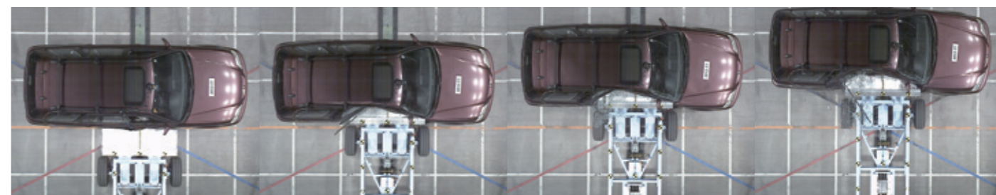
ムービングデフォーマルバリアによる側面衝突試験 Side collision test using moving deformable barrier
