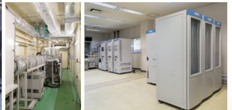
環境型 乗用車用シャシダイナモメータを用いた排出ガス等性能評価システム(環境雰囲気温度可変機能および日射装置を装備 WLTTP対応型) Performance evaluation system for exhaust gas, etc. using chassis dynamometer for passenger cars (WLTTP compatible variable-temperature chassis dynamometer system with solar simulation device)
