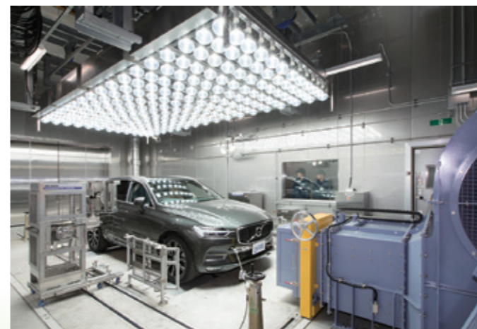
環境型 乗用車用シャシダイナモメータを用いた排出ガス等性能評価システム(環境雰囲気温度可変機能および日射装置を装備 WLTTP対応型) Performance evaluation system for exhaust gas, etc. using chassis dynamometer for passenger cars (WLTTP compatible variable-temperature chassis dynamometer system with solar simulation device)
