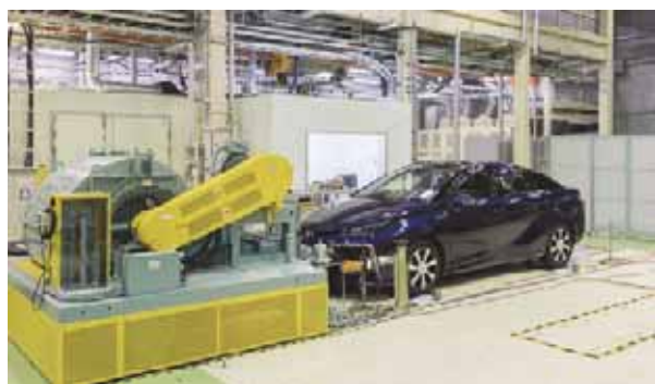
図5.14 シャシダイナモメータを用いた電動車両の性能評価例
