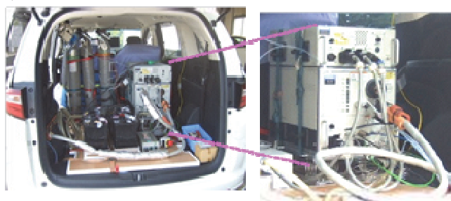
図5.7 車載型排出ガス分析装置(PEMS)を用いた測定の一例
