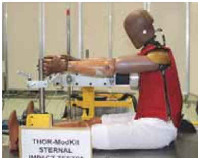
図5.27 人体忠実度の高い前面衝突用人体ダミーに対する衝撃試験
