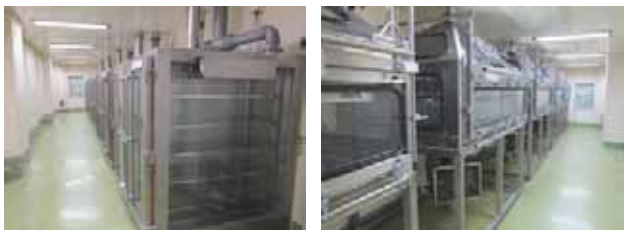
図5.2 自動車排出ガス吸入暴露装置 (左：大型チャンバ、右：中型チャンバ)
