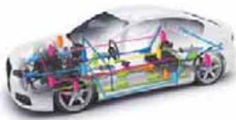
図 5.43 現在の車のE/Eシステム(車載ECU)搭載イメージ
