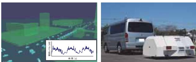
図5.4 道路交通騒音の予測例とタイヤ/路面騒音測定装置(CPXトレーラ)
