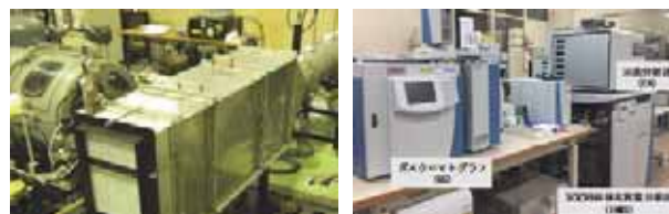
図5.5 ブレーキ摩耗粉塵測定用の試験機器と高感度分析機器の例(安定同位体比質量分析計)
