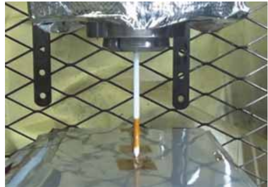
図 5.21 内部短絡模擬試験 (先端 Ni チップ付セラミック釘刺試験)
