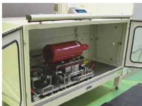
図5.15 質量法によるFCVの水素消費量計測例
