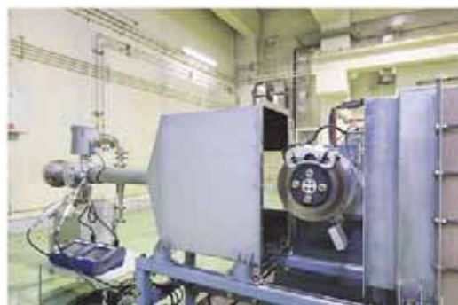
図5.12 エンジンダイナモメータを用いたブレーキ粉塵試験
