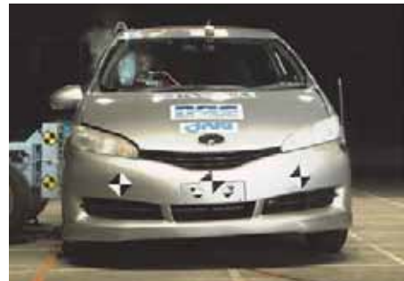
図5.35 走行台車による側面衝突試験
