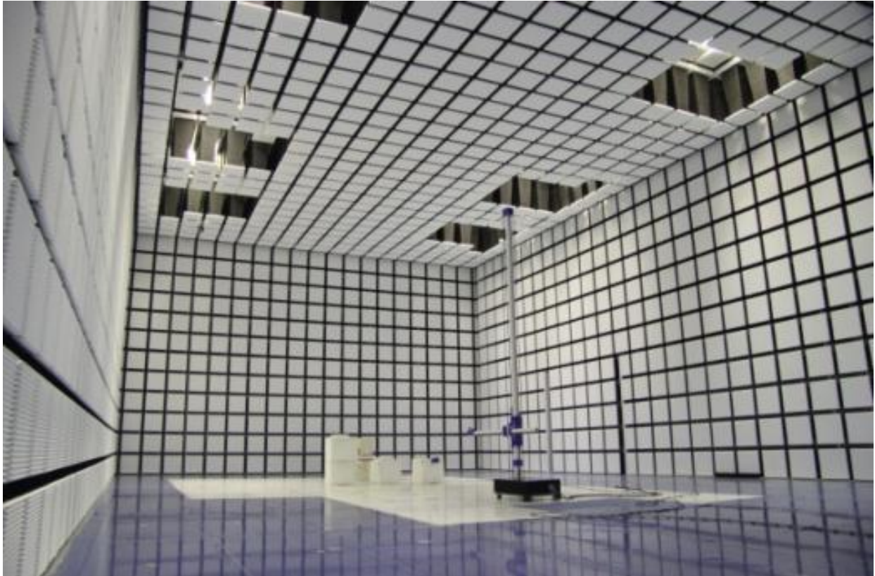
10m法電波暗室全景
