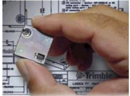
図 1.1 LassenSQ モジュールの外観
