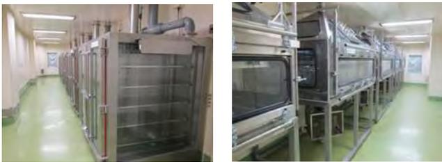
図14 自動車排出ガス吸入暴露装置
