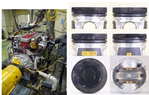
ディーゼルエンジン油試験ベンチ 200時間運転後ピストン堆積物の例
