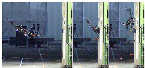
図50 ドローン実験（固定壁衝突）の一例
