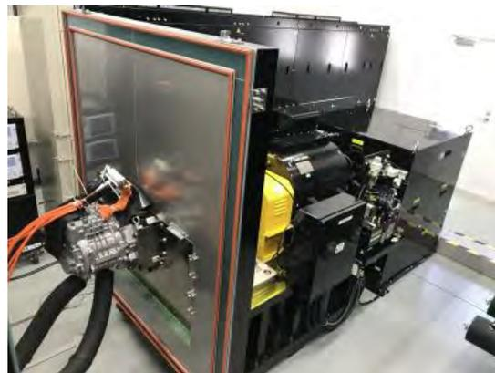
図5 400kW級モータダイナモメータ
