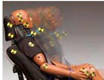
図 31 シートの鞭打ち低減性能評価試験
