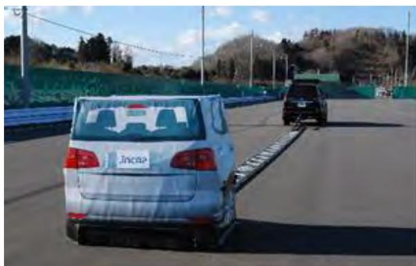
図 40 車両（CCRm）ターゲット装置
