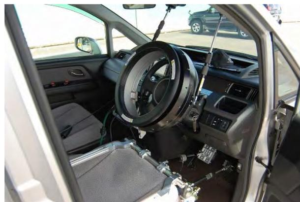
図 42 運転操作ロボット
