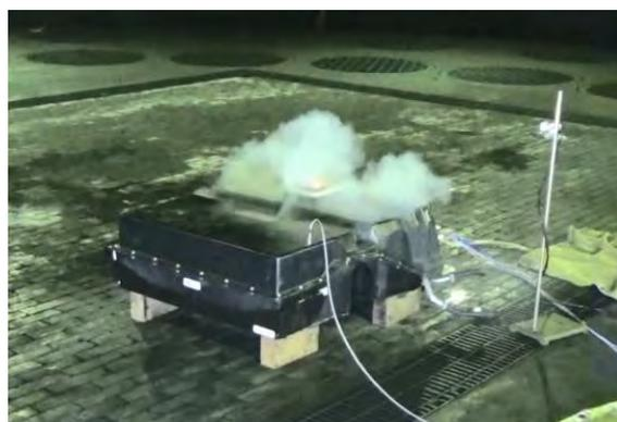
図 17 車載用電池パックによる熱連鎖試験
