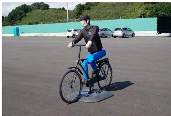
図 43 自律走行型 自転車ターゲット装置
