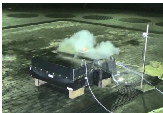
図 17 車載用電池パックによる熱連鎖試験
