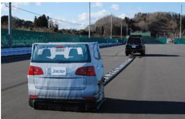
図 40 車両（CCRm）ターゲット装置
