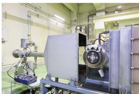
図 20 エンジンダイナモメータを用いた ブレーキ粉塵試験
