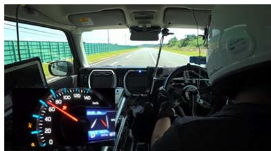
図47 車線逸脱抑制装置等性能試験
