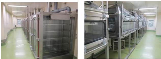
図14 自動車排出ガス吸入暴露装置 (左：大型チャンバ、右：中型チャンバ)
