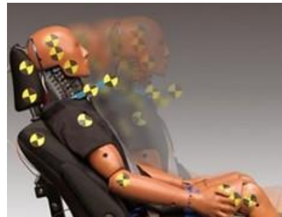
図31 シートの鞭打ち低減性能評価試験
