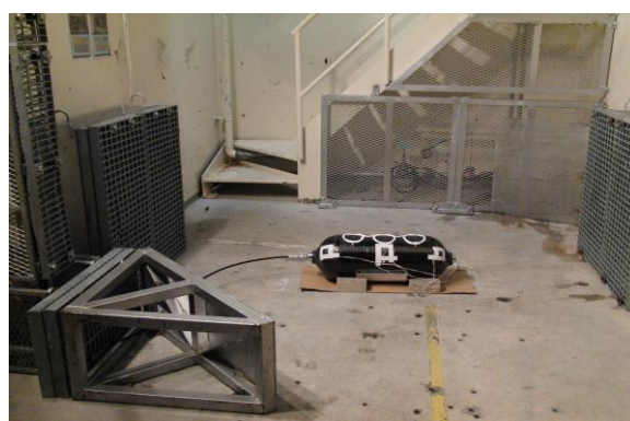
図26 液圧試験ピット
