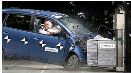
図30 デフォーマブルバリアへの前面衝突試験
