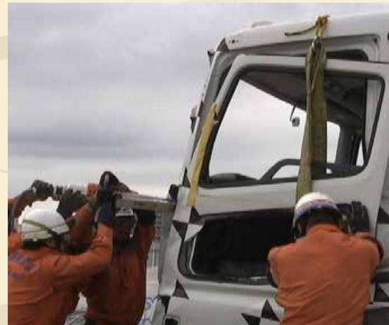
ドア前角のカバーを油圧スプレッダで潰すとヒンジが見える。
