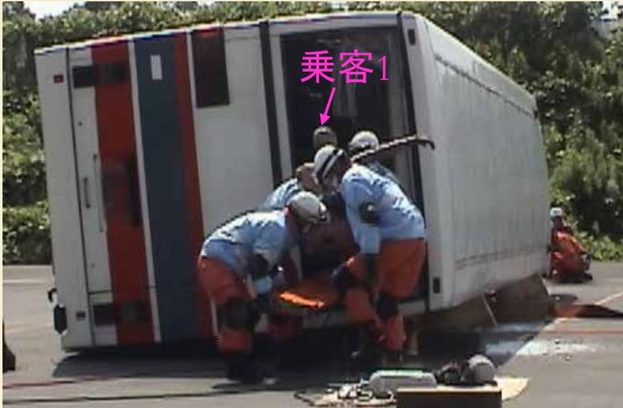
挟まれている周辺をエアマットで持ち上げることにより、挟まれている人体部位と車体の間に隙間を作り、室内に体全体を取り込む。
