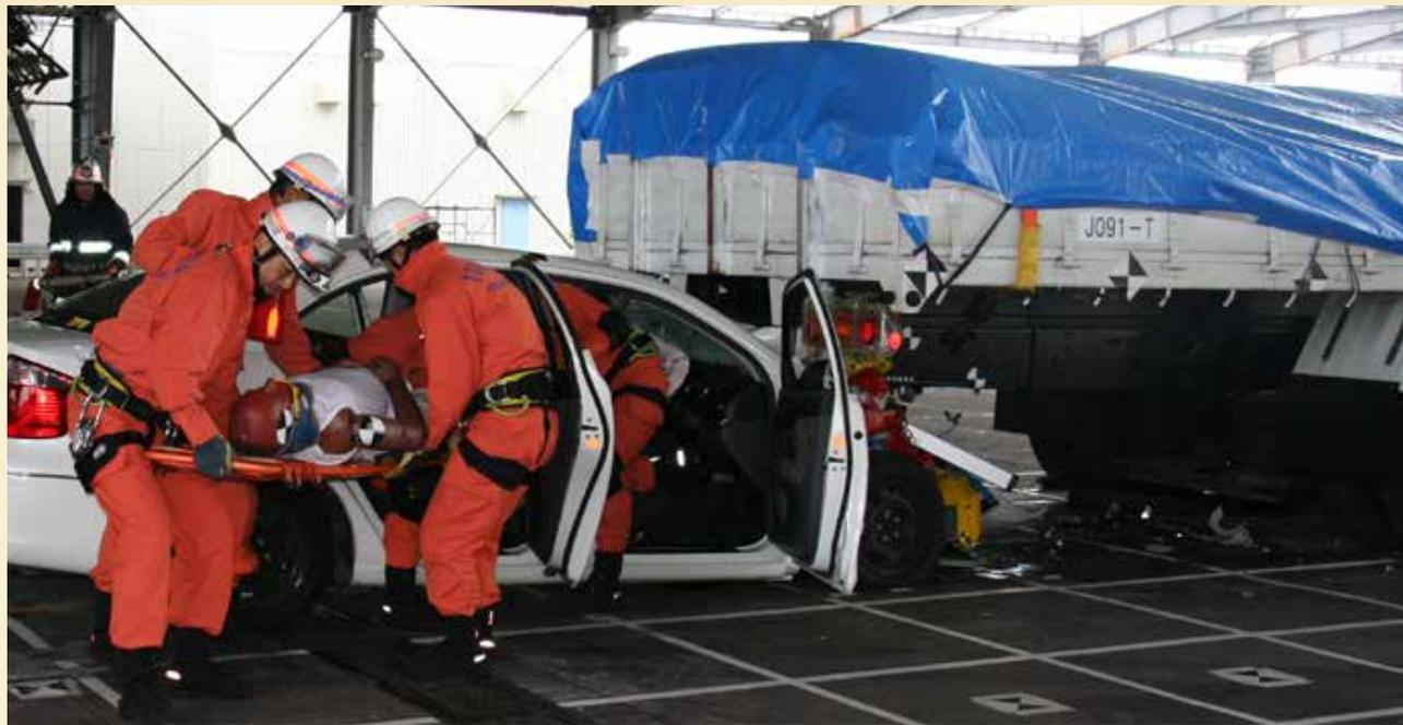
乗用車の前面衝突(後部が衝突していない場合), 後席ドアの変形が少ないため, 後席ドアの方が開扉しやすい.
