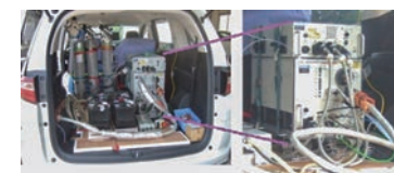
車載式排出ガス測定システム（PEMS：Portable Emissions Measurement System）
